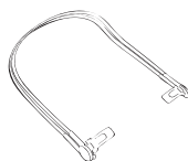
drátěná výztuž stříšky kočárku a příchytky
